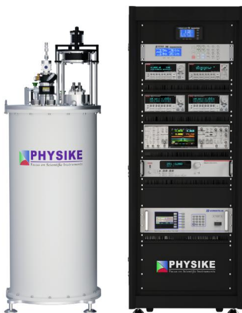
典型低温强磁场物性测试系统(TKMS)
